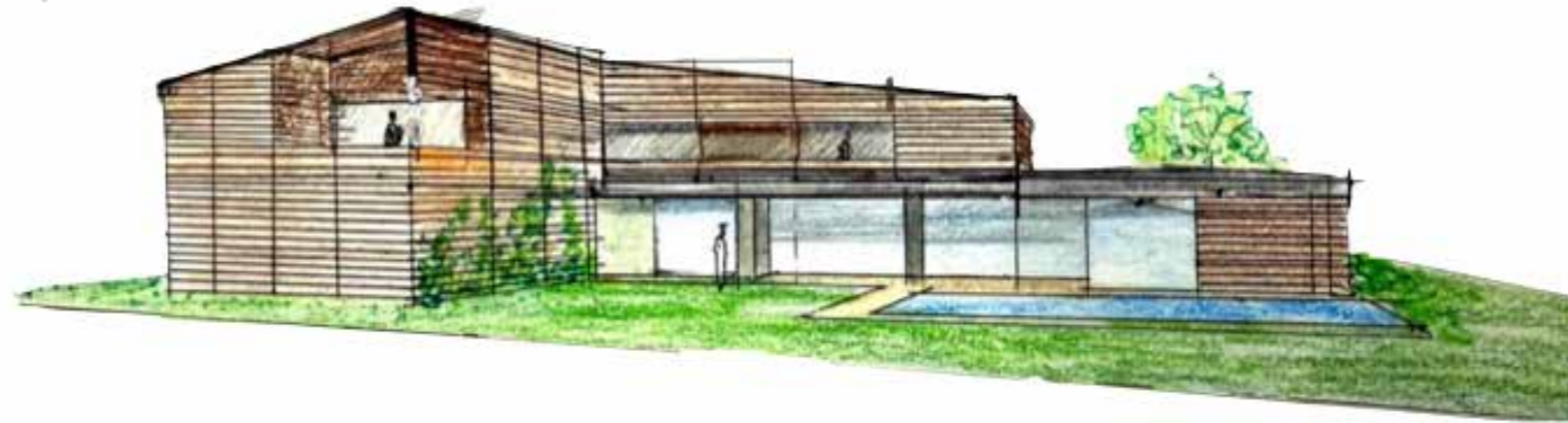
Scuri scorrevoli necessari a chiudere le ampie superfici vetrate costituite da serramenti metallici in alluminio anodizzato color bronzo con sezioni di profilo essenziali e di dimensioni ridotte e vetri reflex.
