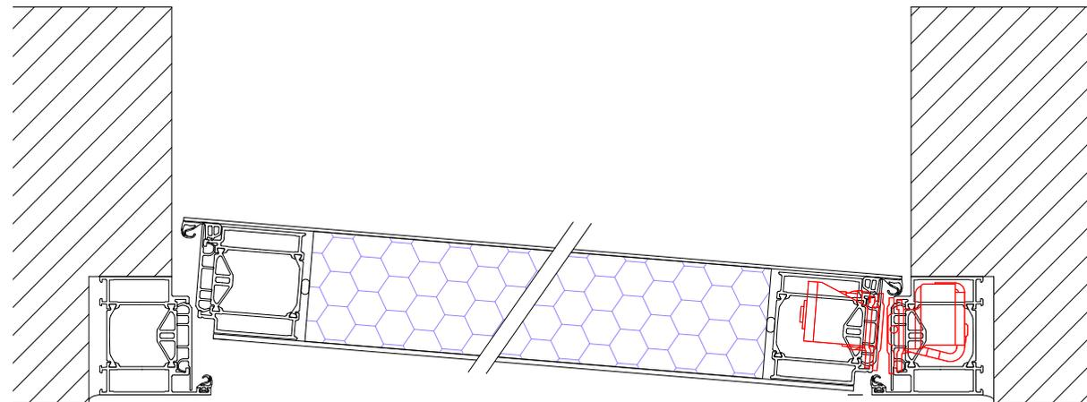
Portoncino in alluminio TT con telaio e anta complanari sp= 75 mm
